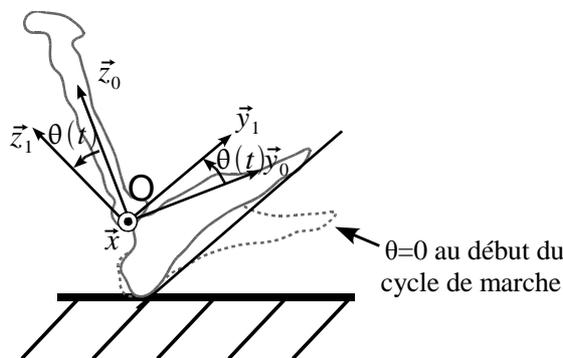
Illustration 5: Paramétrage du modèle de solides indéformables pied/tibia
