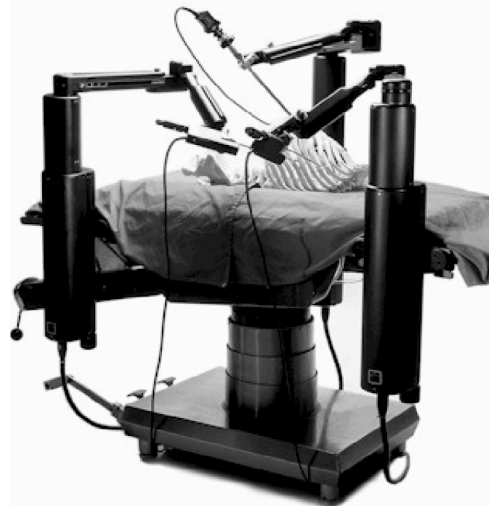
Photo N°1-5 : les trois robots esclaves
